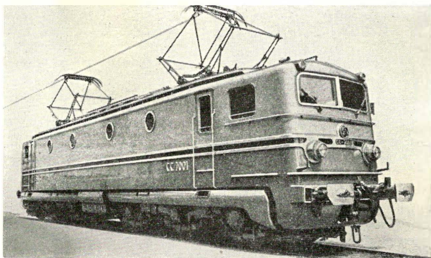
Fig. 2. Fransk elektrolokomotiv til eksprestogsdrift, 4300 hk ved timeydelse, vægt 102 t, konstruktionshastighed 160 km/h, maksimalhastighed 243 km/h, hvilket er verdensrekord.
